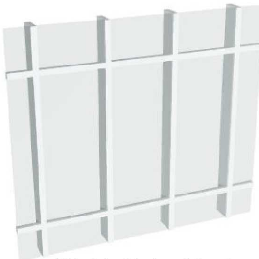
rys. Układ słupków i rygli fasady
